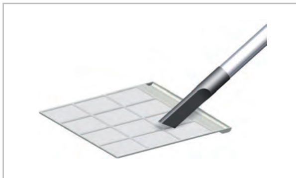
Abb. 30: Reinigung mit dem Staubsauger
