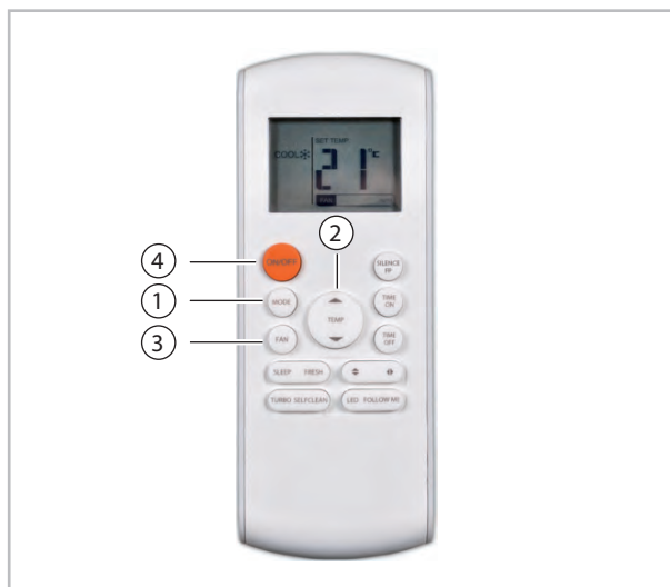
Abb. 9: Modus "Kühlen", "Heizen" und "Umluft"
