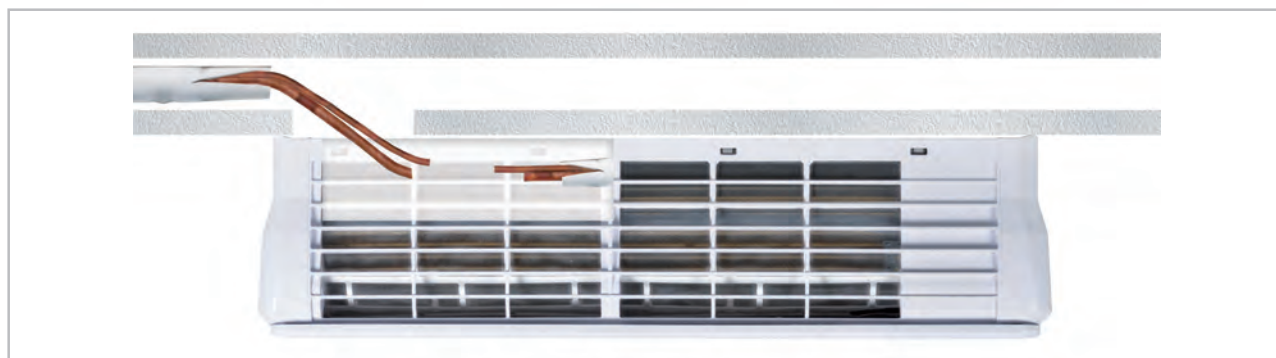
Abb. 31: Unterputzinstallation der Kältemittelleitungen (Ansicht von oben)
