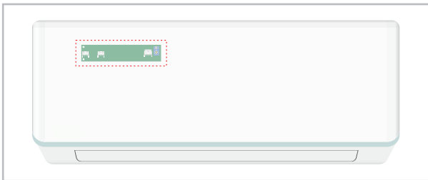
Abb. 48: Eibauposition der Adapterplatine
